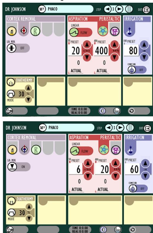
O modo I/A gera vácuo através de uma bomba peristáltica ou Venturi seleccionável.
