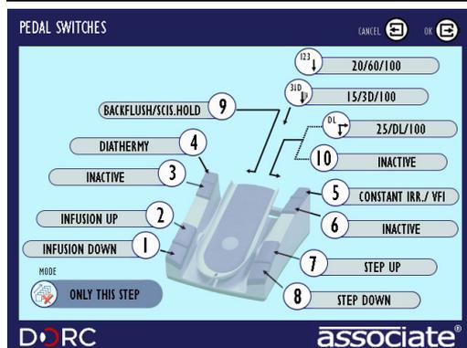
Figura 82 Esquema do interruptor de pé
